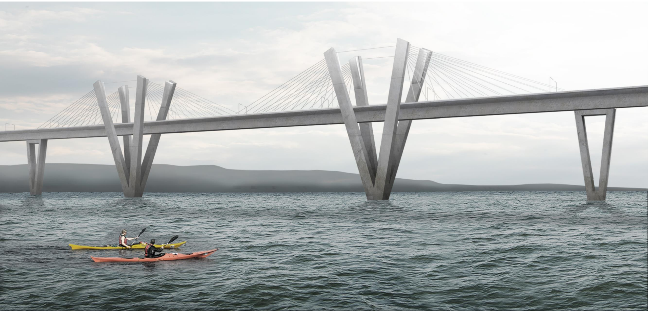
Gennemsejlingsfaget – udformet som V- formede skrånede søjler der formmæssigt tager afsæt i bygværkets øvrige søjler
